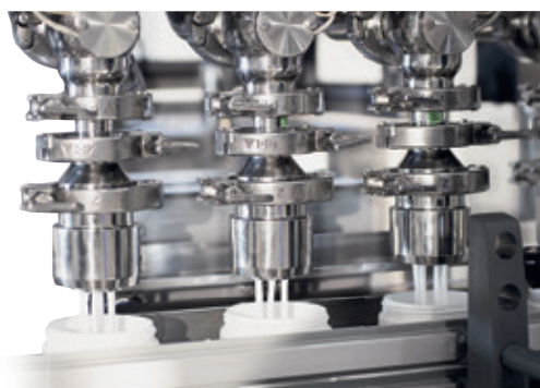
Riempimento di tipologie diverse di prodotto e fase intermedia di lavaggio integrato
