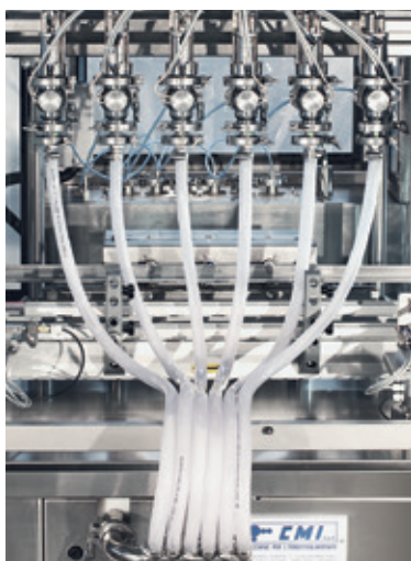
Riempimento di tipologie diverse di prodotto e fase intermedia di lavaggio integrato
