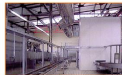
CELLA DI LIEVITAZIONE COMPLETA CON CONTROLLO AUTOMATICO DELLE CONDIZIONI DI LIEVITAZIONE PROOFING CELL COMPLETE WITH AUTOMATIC CONTROL OF THE PROOFING CONDITIONS
