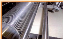
CONTROLLO ELETTRONICO QUANTITÀ PASTA NELLA TRAFILA ELECTRONIC CONTROL OF DOUGH QUANTITY IN THE GROOVED CYLINDER
