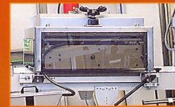
CILINDRO LAMINAZIONE TRASVERSALE CON SOLLEVAMENTO PNEUMATICO PER PULIZIA RAPIDA CROSSING LAMINATION CYLINDER WITH PNEUMATIC LIFTING FOR A RAPID CLEANING
