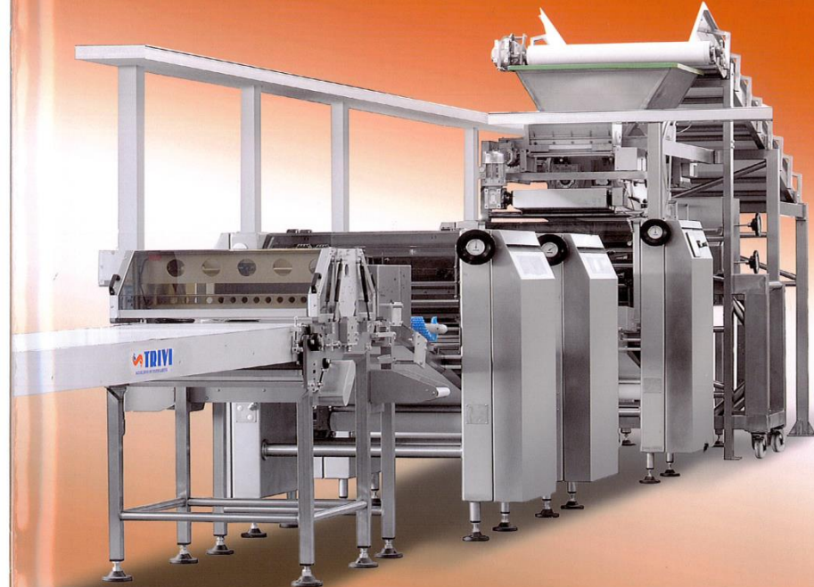
SFARINATORE CON ATTACCO RAPIDO PER MIGLIORARE LA PULIZIA DELLA VASCA FLOUR DUSTER WITH RAPID CONNECTION TO IMPROVE THE CLEANING OF THE TANK
