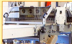
TAGLIERINA A GHIGLIOTTINA PER FORMATI RETTANGOLARI SENZA SCARTO GUILLOTINE CUTTING MACHINE FOR RECTANGULAR SHAPE WITHOUT SCRAPS
