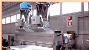
DISTRIBUZIONE AUTOMATICA SESAMO E GRANAGLIE SULLA SUPERFICIE DEL PRODOTTO AUTOMATIC DISTRIBUTION OF SESAME AND GRAINS ON PRODUCT SURFACE
