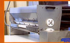
SFARINATORE CON ATTACCO RAPIDO PER MIGLIORARE LA PULIZIA DELLA VASCA FLOUR DUSTER WITH RAPID CONNECTION TO IMPROVE THE CLEANING OF THE TANK
