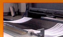
FORMATURA E ARROTOLATURA FILONI LOAVES MAKE UP AND ROLLING UP
