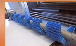
PULITURA SUPERFICIALE PASTA DOUGH SUPERFICIAL CLEANING
