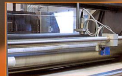
GRUPPO DI CALIBRATURA CON CONTROLLO ELETTRONICO TENSIONE PASTA CALIBRATION GROUP WITH ELECTRONIC CONTROL OF DOUGH TENSION
