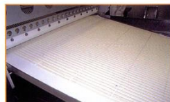
CONTROLLO AUTOMATICO DELLA DISTANZA GRISSINI SULLA TEGLIA AUTOMATIC CONTROL OF THE BREADSTICKS DISTANCE ON THE TRAY
