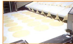
RECUPERO RIFIUTI CON POSSIBILITÀ DI RICICLO IN ESTRUSORE SCRAPS COLLECTION WITH POSSIBILITY OF RECYCLING IN EXTRUDER
