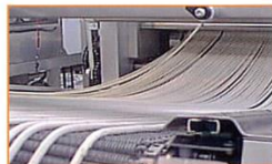
DISTANZIAMENTO GRISSINI REGOLABILE E GUIDATO CON CILINDRI MOTORIZZATI ADJUSTABLE BREADSTICKS DISTANCING GUIDED BY MOTORIZED CYLINDERS
