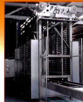
CELLA AUTOMATICA PER RAFFREDDAMENTO PRODOTTI AUTOMATIC CELL FOR PRODUCT COOLING
