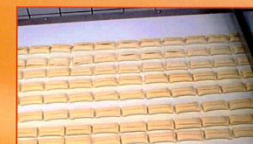
CHIUSURA E TAGLIO TRASVERSALE DEI PRODOTTI PRODUCTS CLOSURE AND CROSSING CUTTING
