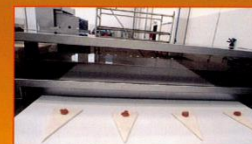
DEPOSITO CREME PRIMA DELLA ARROTOLATURA CREAMS DEPOSIT BEFORE ROLLING UP PHASE
