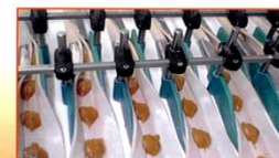
PIEGATURA SFOGLIA CON DOSAGGIO CREMA IN AUTOMATICO DOUGH SHEET FOLDING WITH AUTOMATIC CREAM DOSAGE
