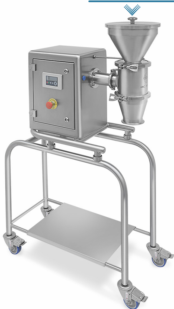
Tramoggia per carico manuale Hopper for manual loading
