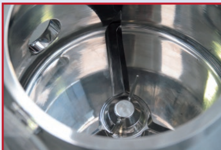
Pala di miscelazione e granulazione a 3 razze Mixing and granulating blade with 3 coilers
