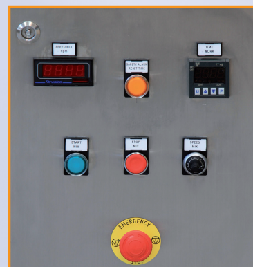
Pannello di comando per gestione manuale Control panel for manual machine operation
