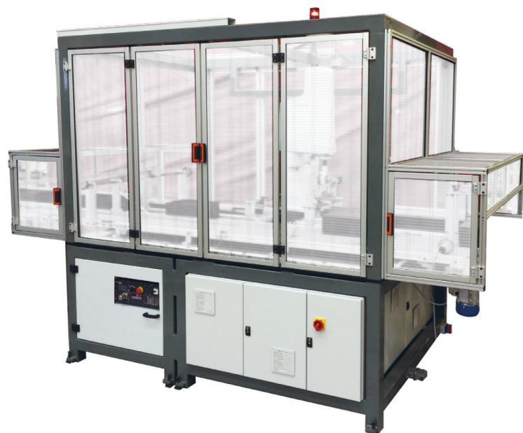
La tappatrice/riempitrice MC82 è la macchina automatica meccatronica di riferimento per la produzione ed il riempimento di scatole rigide tappate "di medio-grande formato". Installata a valle di una linea per la produzione di scatole rigide "doppia" oppure "tripla", inserisce uno ad uno i coperchi sui fondi, senza impilare verticalmente le scatole tappate.
