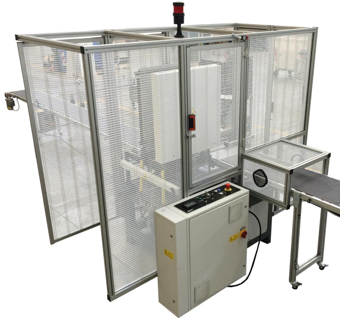
La tappatrice MC L/99 è la macchina automatica di riferimento per la produzione di pile di scatole tappate. Installata a valle di una linea doppia per la produzione di scatole in cartone teso rivestite, inserisce uno ad uno i fondi dentro i coperchi ed impila verticalmente le scatole tappate.
