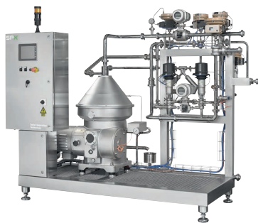
MEIJERI - MAITOSEPARAATTORI AUTOMAATTISELLA MAIDON/KERMAN VAKIOINTIJÄRJESTELMÄLLÄ.
