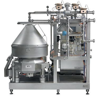
MEIJERI - MAITOSEPARAATTORI AUTOMAATTISELLA MAIDON JA KERMAN VAKIOINTIJÄRJESTELMÄLLÄ.
